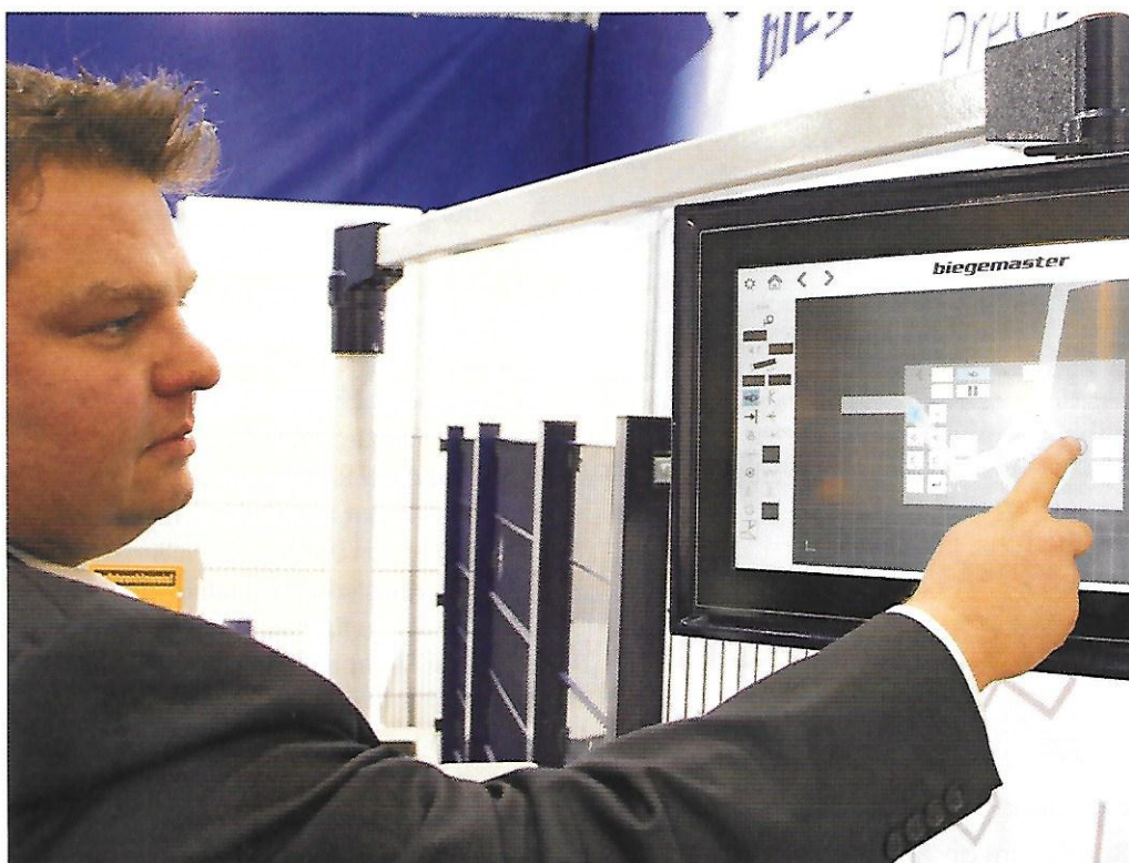
Vertriebsleiter Mario Traub zeigte den Messebesuchern, wie mit der neuen Multi-Touch-Steuerung individuelle Kantprofile mit wenigen Fingertipps erstellt werden.
